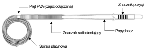
Rysunek 2. Schemat urządzenia ED COIL ze znacznikiem pozycji
